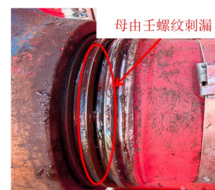
(b) 母由壬螺纹刺漏
