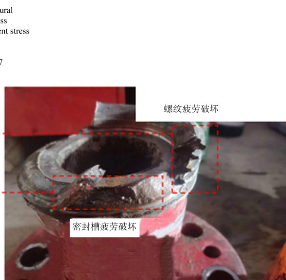
图 6 原结构连接由壬在复合载荷下的有限元等效 von-Mises 应力云图与实物断裂形貌对比
